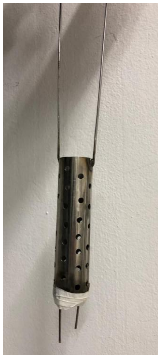
Figura 6 – adaptador para manter palhetas acima do vapor de nitrogênio dentro do próprio botijão, em protocolos de congelamento rápido de sêmen.
