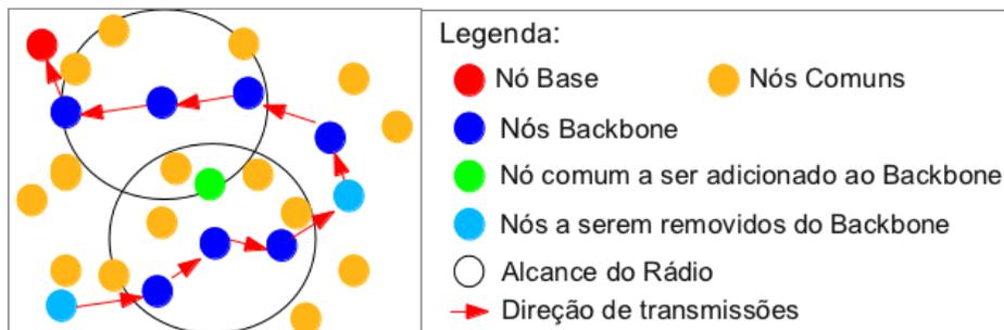
**Figura 10:** Exemplo de um *backbone* formado sem otimizações.
