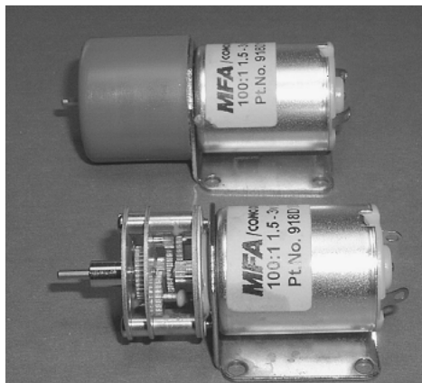
Figura 2.9: Exemplo de motor DC com caixa de redução - Fonte: (LOVINE, 2004)
