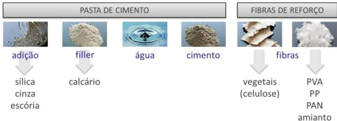
Figura 1 - Materiais que compõem o fibrocimento.
