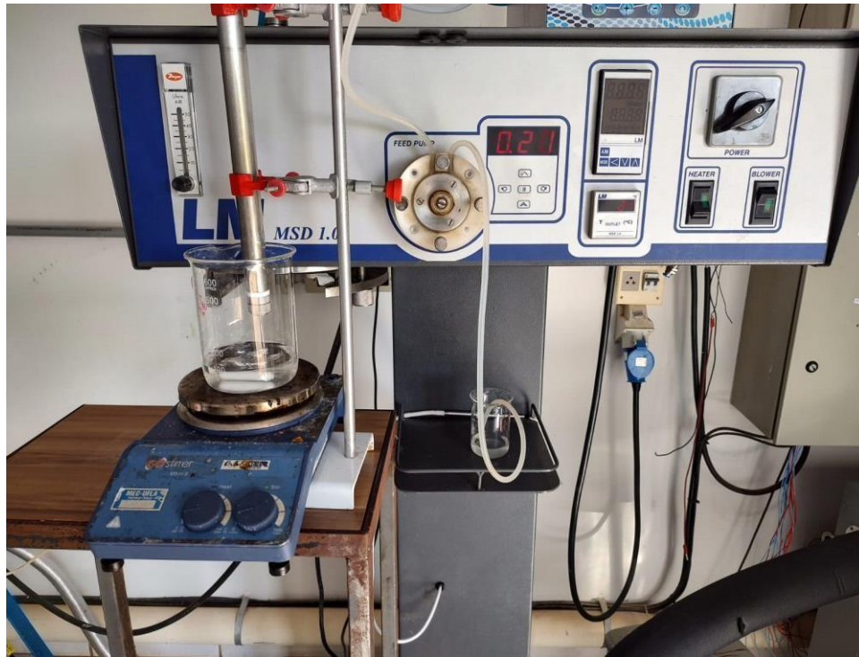
Figura 8 – Montagem do sistema de bico atomizador duplo fluido adaptado para produção das microesferas.
