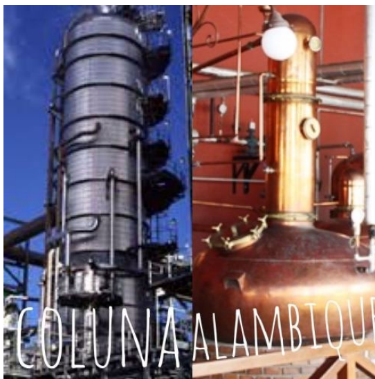
Figura 46 - Coluna destilação à esquerda e alambique de cobre à direita
