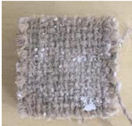
Figura 2 – Compósito laminado de gesso reforçado com polpa celulósica e manta de juta
