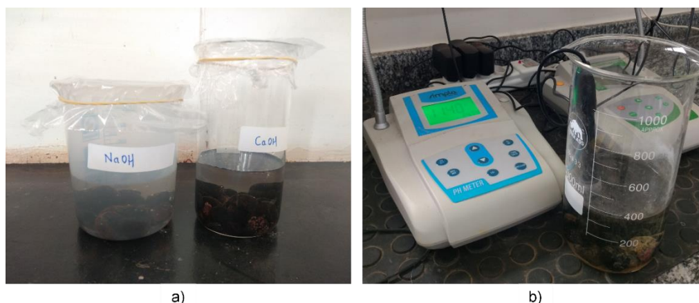
Figura 10. Ensaio de durabilidade. a) Endocarpos submersos em solução de \text{Ca(OH)}_2 e NaOH; b) Medição do pH das soluções com o auxílio de pHômetro.
