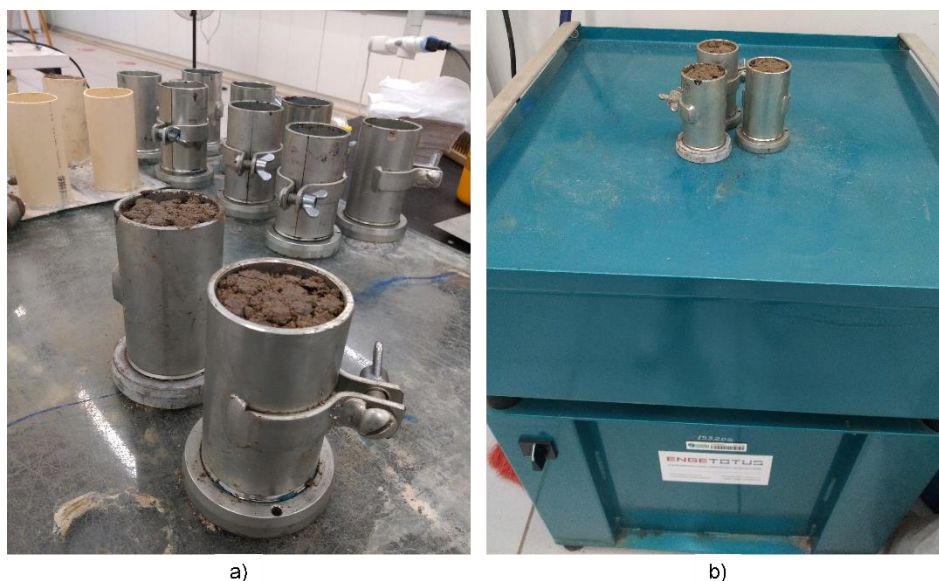
Figura 14. a) Misturas colocadas nos moldes cilíndricos metálicos; b) Mesa vibratória.
