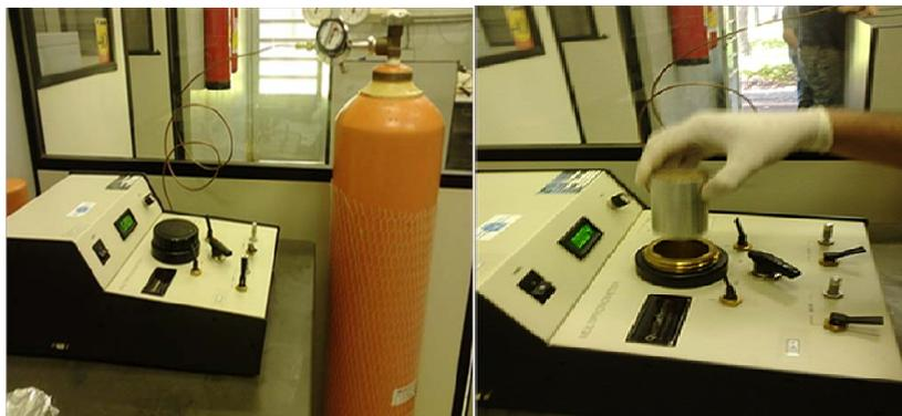
Figura 20 Multipcnômetro de gás hélio, utilizado na determinação da densidade real
