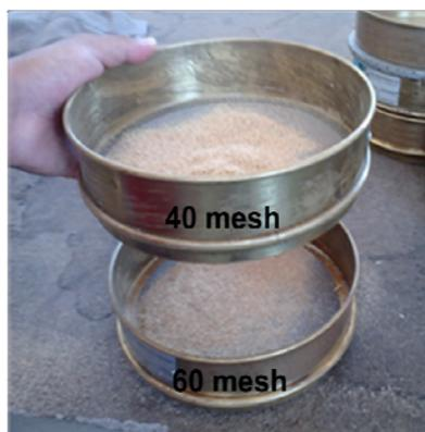
Figura 18 Material sendo peneirado
