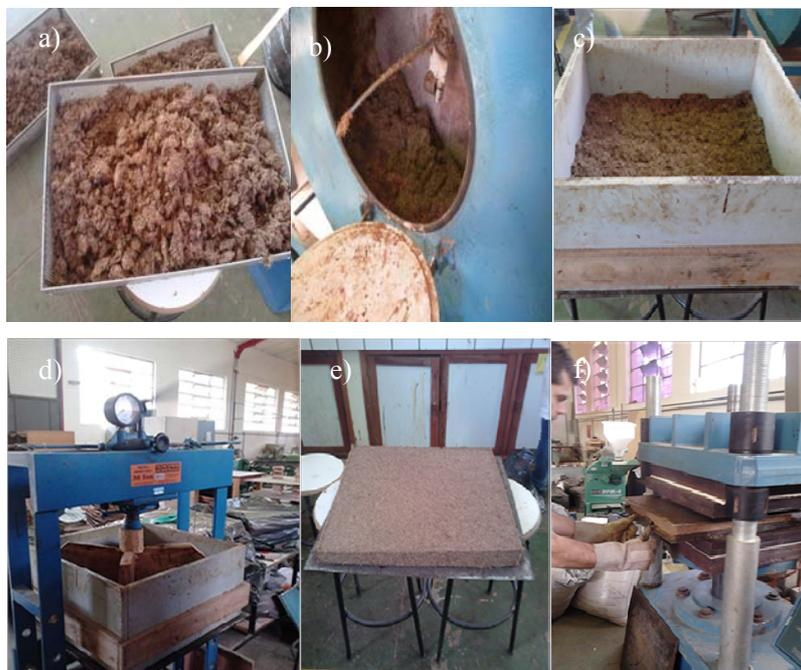
Figura 21 Etapas do processo produtivo dos painéis aglomerados, sendo a) partículas tratadas e secas; b) tambor giratório para encolamento das partículas; c) caixa formadora de colchão; d) pré- pensagem; e) formação do colchão e f) prensagem a quente.
