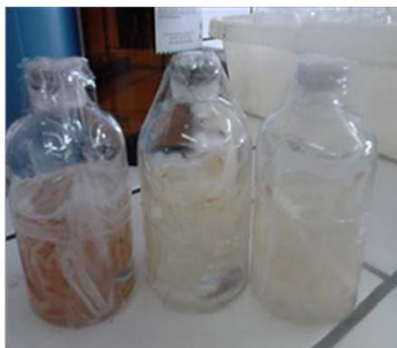
Figura 12 Fibra do pseudocaule armazenada em solução para posterior maceração
