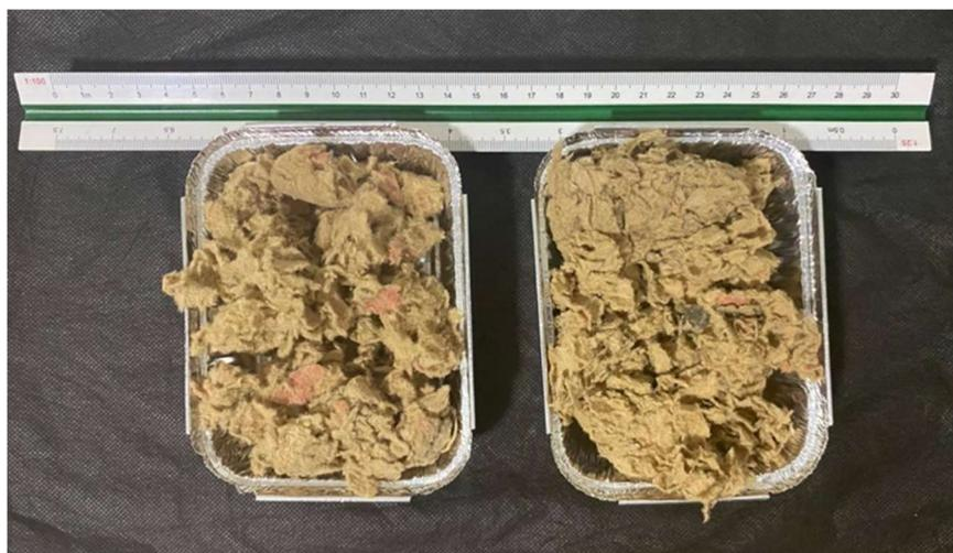
Figura 9: Fibras kraft obtidas após processamento de trituração
