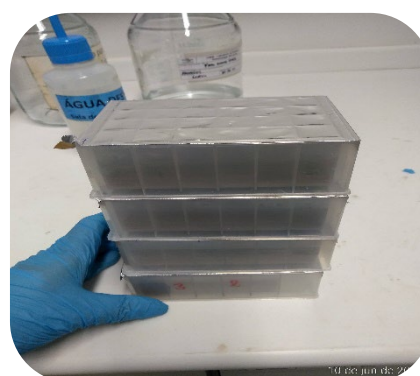
Placa DeepWell de 24 poços vedada para reação de hidrólise
