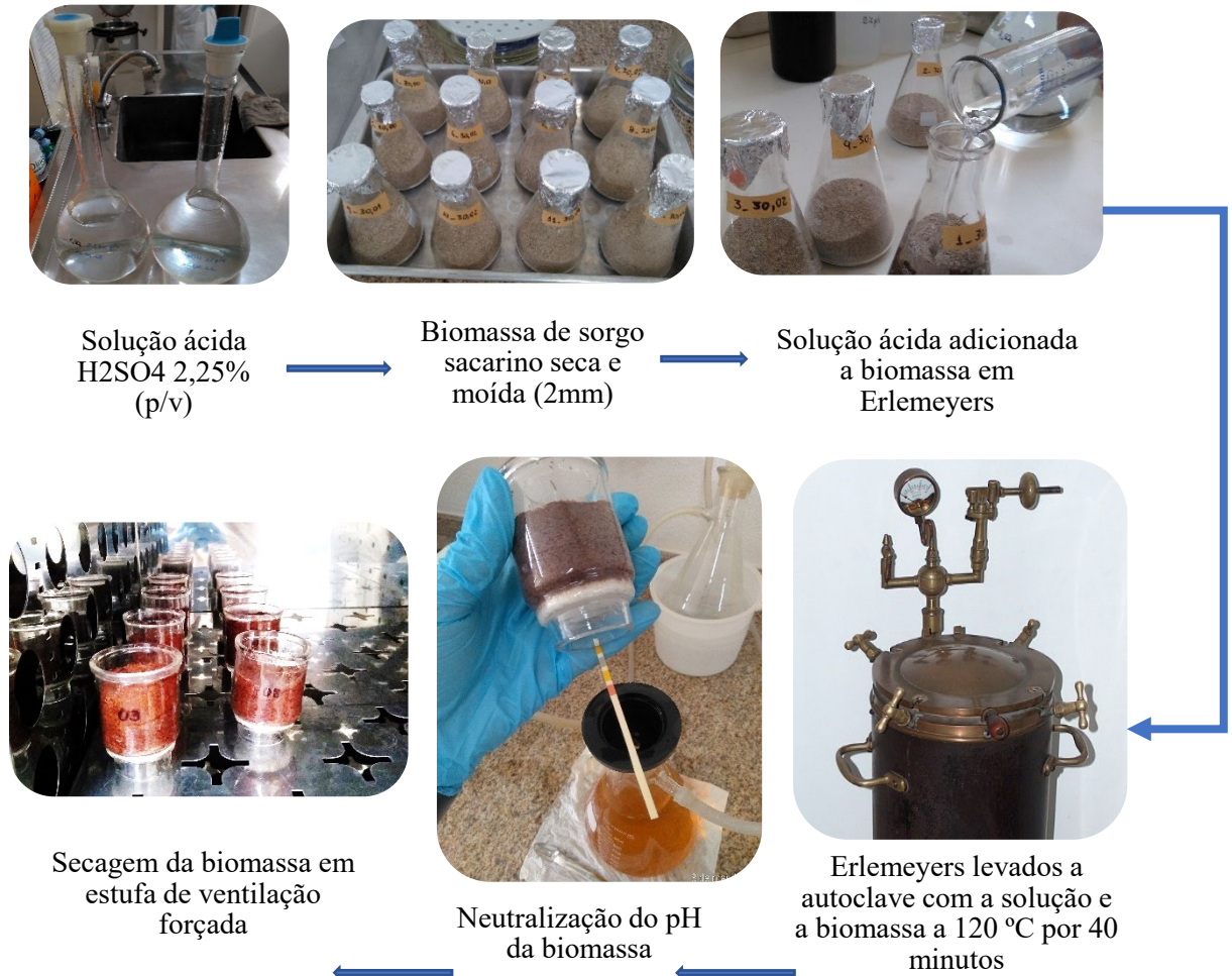
Figura 38: Esquema de pré-tratamento ácido da biomassa de sorgo sacarino
