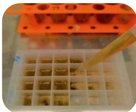
Placa DeepWell de 24 poços contendo biomassa de sorgo sacarino e volume reacional enzimático
