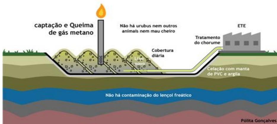
Figura 4 – Esquema de um aterro sanitário (www.lixo.com.br, acessado em 07/01/2013).
