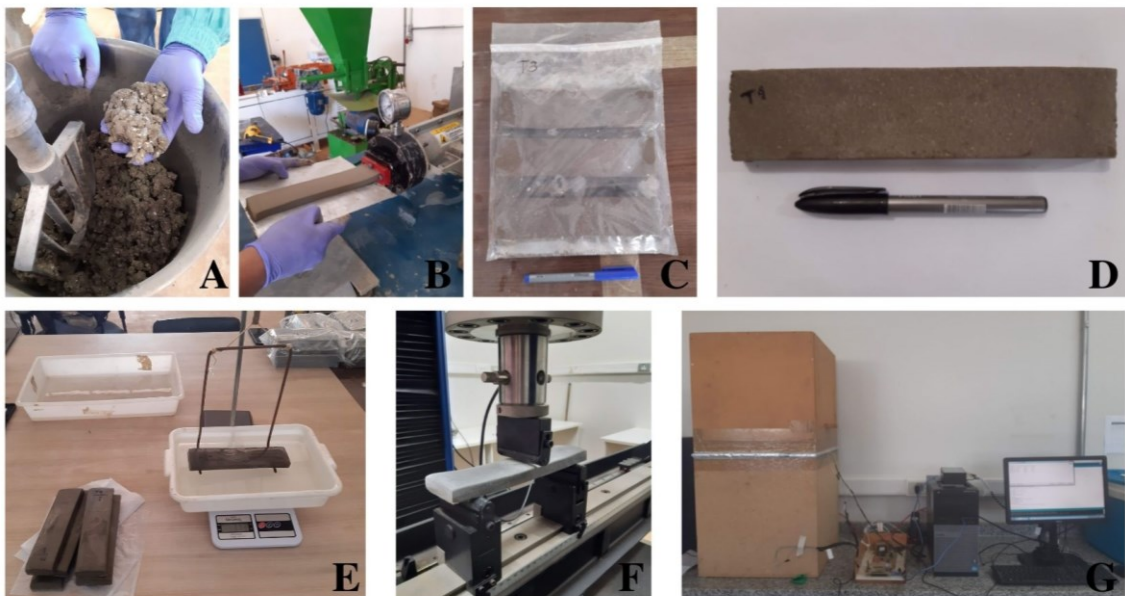
Figura 1 - Sequência de produção dos fibrocimentos.
