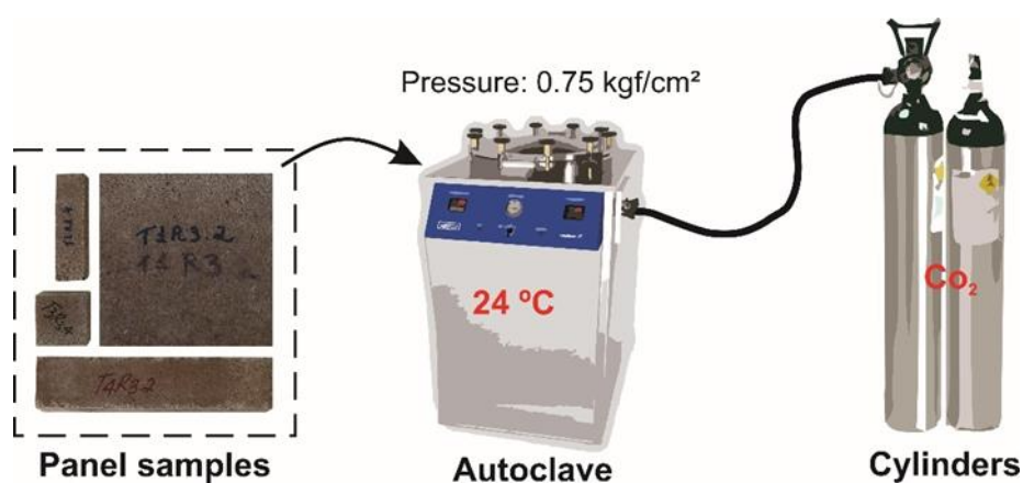
Figura 1. Processo de carbonatação acelerada de painéis cimento madeira
