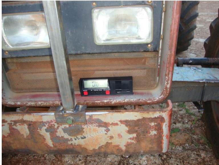
Figura 6.3 – Ponto de medição da inclinação transversal.
