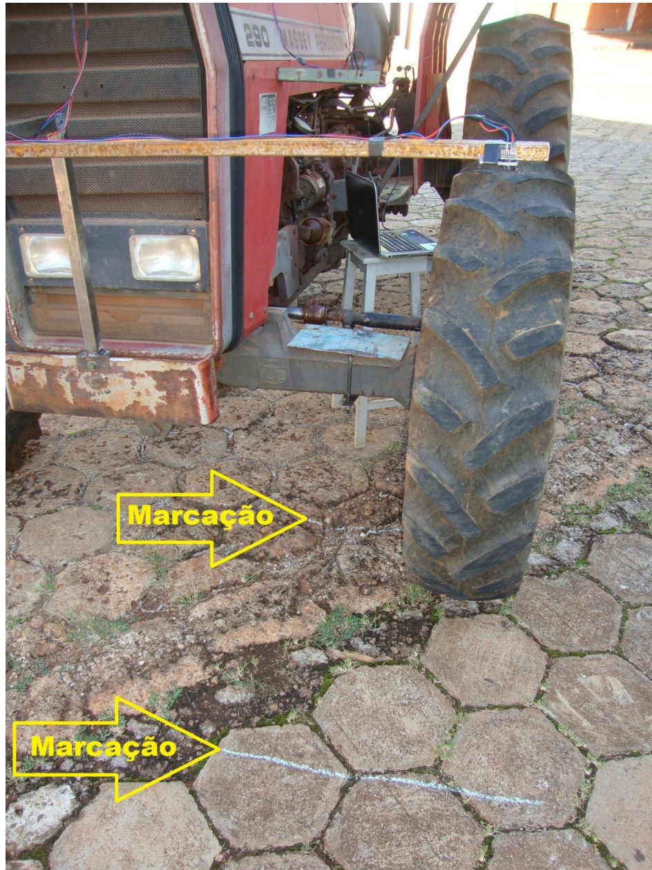
Figura 6.2 – Marcação do ponto de medição do sensor.
