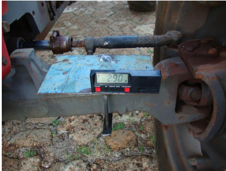
Figura 6.5 – Ponto de medição da inclinação do eixo dianteiro.
