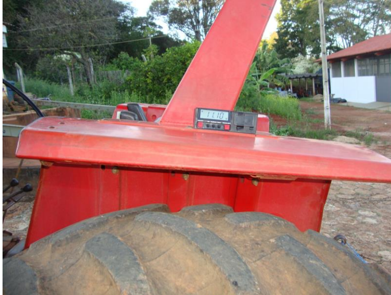
Figura 6.4 – Ponto de medição da inclinação longitudinal.
