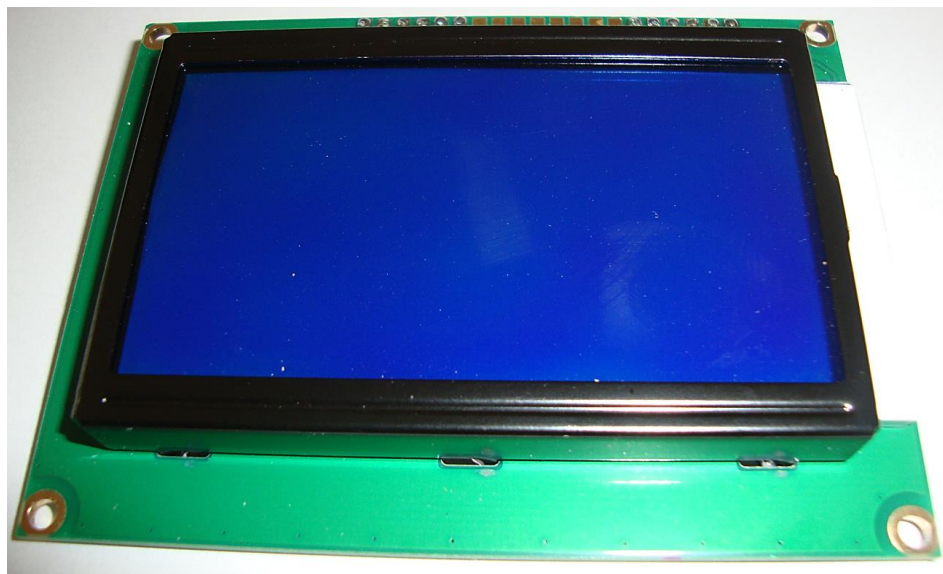
Figura 3.18 – Display de cristal líquido.
