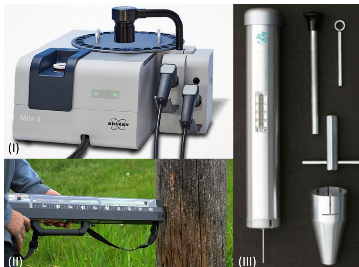
Figura 5 - Equipamentos não-destrutivos para determinação da densidade básica da madeira (I) Espectômetro Multiuso MPA II Bruker®, (II) Resistograph® e (III) Pilodyn®.
