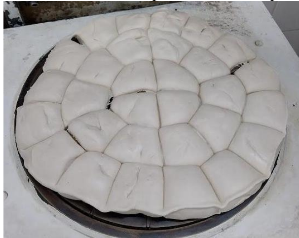
Figura 17 – Divisão da massa dos pães franceses em prensa divisora.
