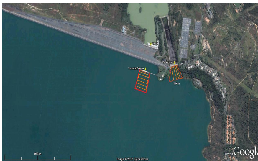
Figura 14 Representação do desenho amostral da coleta de dados hidroacústicos. As linhas paralelas representam os transectos realizados.
