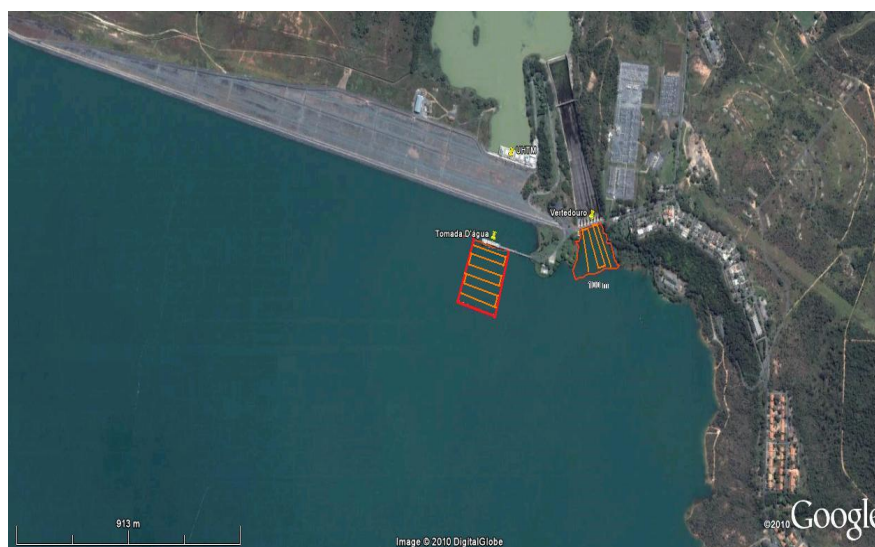
Figura 3 Representação do desenho amostral da coleta de dados hidroacústicos. As linhas paralelas representam os transectos realizados.
