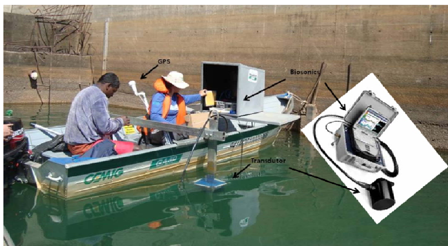
Figura 2: Barco adaptado para aquisição de dados de hidroacústica.
