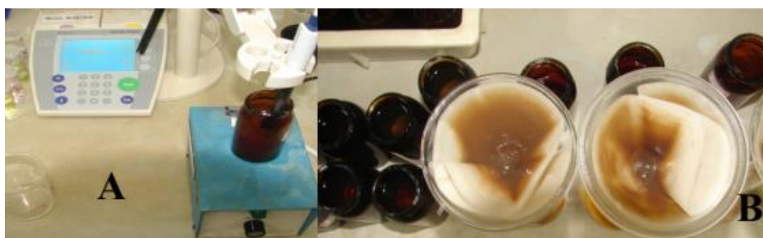
Figura 5. Imagem (A) mostrando o ajuste do pH da solução. Em (B), após ajuste do pH, o processo de filtragem.
