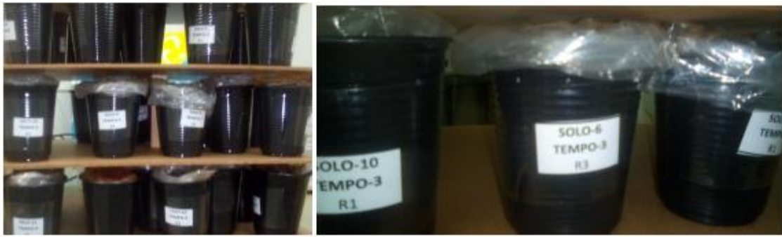
Figura 2. Solos após a contaminação acondicionado em copos de polipropileno preto e capacidade (200 mL).
