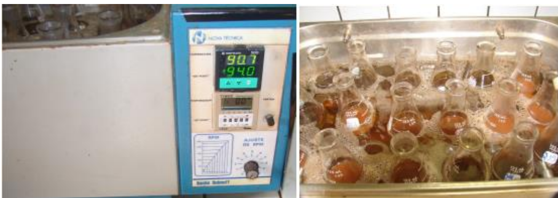
Figura 3. Equipamento de banho maria (90/95 °C) com os erlenmeyers de 250 mL, sob agitação
