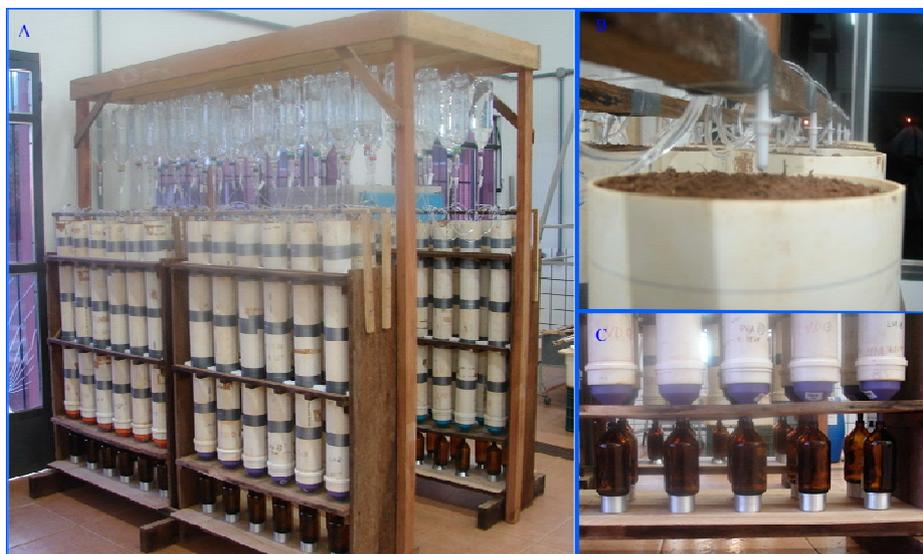
Figura 1 Experimento de lixiviação do tiametoxam em colunas de PVC preenchidas com amostras de um Latossolo Vermelho-Amarelo distrófico, Latossolo Vermelho distroférico e um Argissolo Vermelho-Amarelo (A) e detalhe do sistema (B e C)
