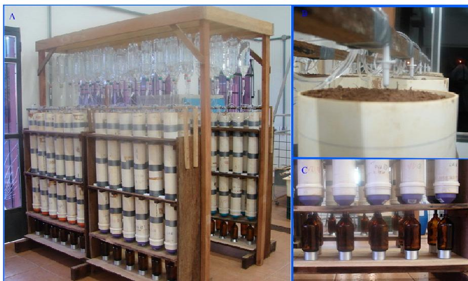
Figura 1 Experimento de lixiviação de nitrogênio e fósforo em colunas de PVC preenchidas com amostras de um Latossolo Vermelho-Amarelo distrófico, Latossolo Vermelho distroférico e um Argissolo Vermelho-Amarelo (A) e detalhe do sistema (B e C)
