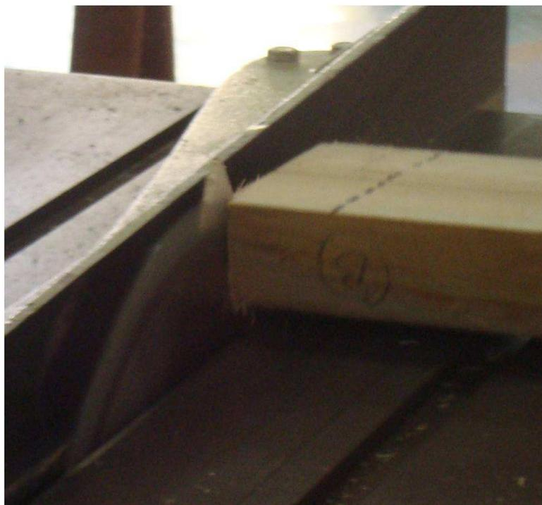
Figura 3 Corte transversal ( $0^{\circ}$ - $90^{\circ}$ ) de 5 mm espessura, realizado com a mesma espessura do dente da serra
