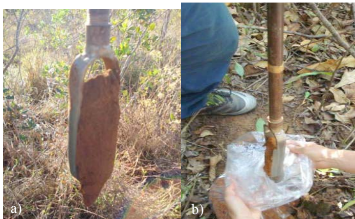
Figura 6 Processo de coleta das amostras de solo, a) Cerca de 20cm de solo foi extraído com auxílio de um trado, b) Armazenamento do solo em sacos plásticos estéreis.
