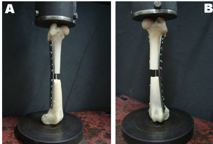
Figura 8 Teste mecânico de compressão utilizando máquina universal de ensaios EMIC DL 30000. A - Corpo de prova fixado com o sistema plate-nail (associação da haste intramedular bloqueada e placa óssea). B – Corpo de prova fixado com o sistema plate-rod (associação do pino intramedular e placa óssea)
