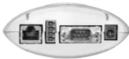
Figura 9 – Visualização da parte traseira e seus conectores de rede da câmera AXIS 2110
