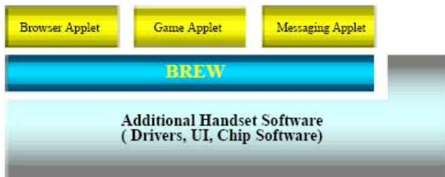
Figura 2.9: Camadas da arquitetura do BREW com uma aplicação
