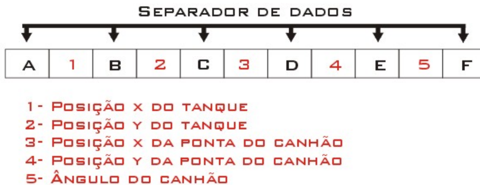
Figura 4.7: Formato da mensagem UDP, a qual envia os parâmetros do tiro
