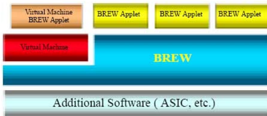
Figura 2.10: Camadas da arquitetura do BREW com máquina virtual
