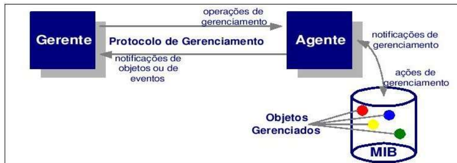
Figura 6 – Principais componentes do Modelo de Gerência OSI e Internet
