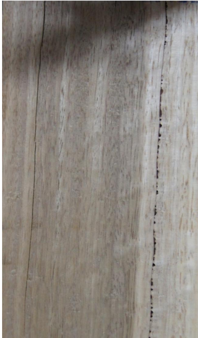
Figura 9 Corpo de prova qualificado de acordo com a classificação da ASTM D 1666-11 (ASTM, 2011) como qualidade da superfície aplainada regular (nota 3)
