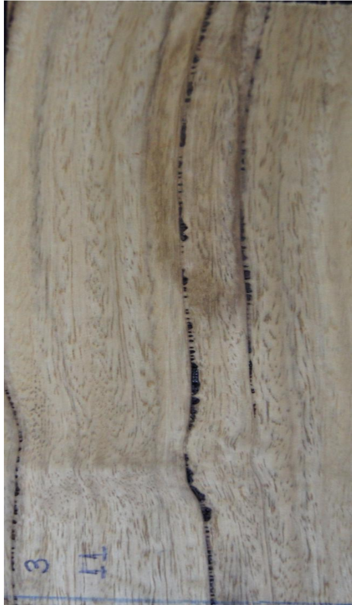
Figura 8 Corpo de prova qualificado de acordo com a classificação da ASTM D 1666-11 (ASTM, 2011) como boa qualidade da superfície aplainada (nota 2)
