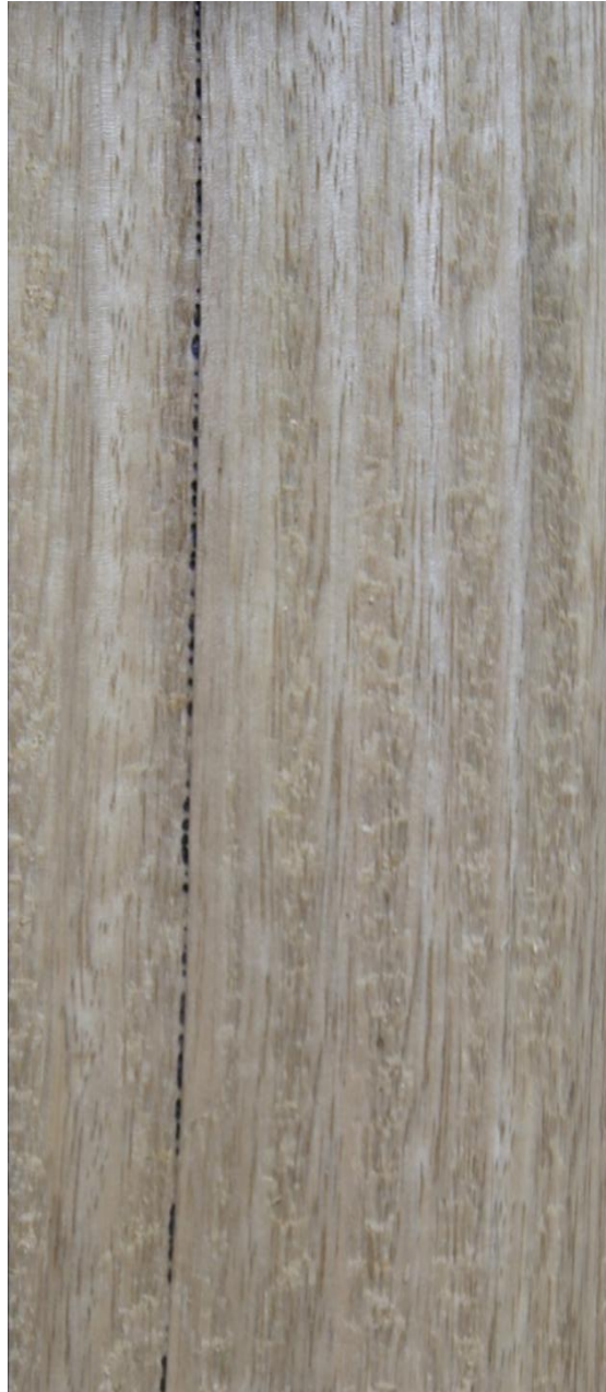
Figura 11 Corpo de prova qualificado de acordo com a classificação da ASTM D 1666-11 (ASTM, 2011) como qualidade da superfície aplainada muito ruim (nota 5)
