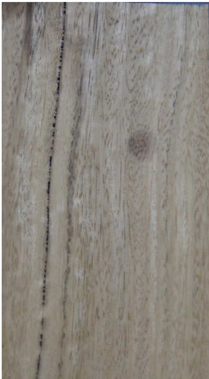
Figura 7 Corpo de prova qualificado de acordo com a classificação da ASTM D 1666-11 (ASTM, 2011) como excelente (nota 1)
