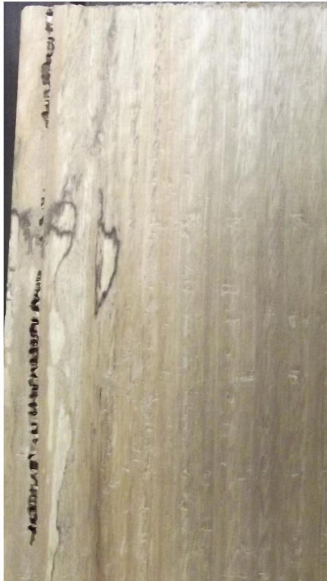
Figura 10 Corpo de prova qualificado de acordo com a classificação da ASTM D 1666-11 (ASTM, 2011) como qualidade da superfície aplainada ruim (nota 4)
