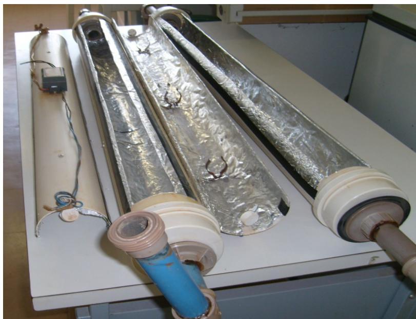
Figura 2. Fotografias dos foto reatores em fase de montagem.
