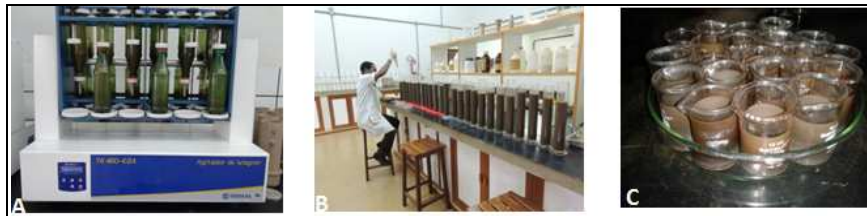
Figura 6 (A) Agitador horizontal; e (B) coleta de alíquota de 10 mL de argila e C- argila precipitada no Béquer de 10 mL
