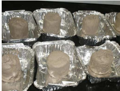
Figura 7 Amostras de solo sob arroz inundado seco na estufa para análise de densidade. Notar a estrutura maciça (sem poros aparentes)
