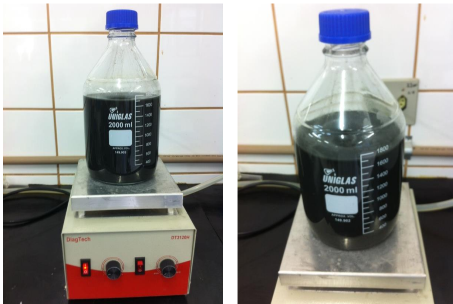
Figura 8 Reator laboratorial, em agitação sobre chapa magnética, utilizado na realização do ensaio de biodegradabilidade anaeróbia da água residuária da lavagem das baias dos cães do canil Parque Francisco de Assis em Lavras-MG.
