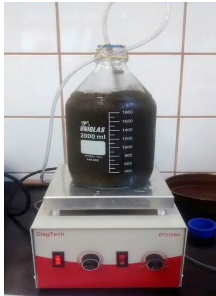
Figura 7 Reator laboratorial, em aeração e agitação sobre chapa magnética, utilizado na realização do ensaio de biodegradabilidade aeróbia da água residuária da lavagem das baias dos cães do canil Parque Francisco de Assis em Lavras-MG.
