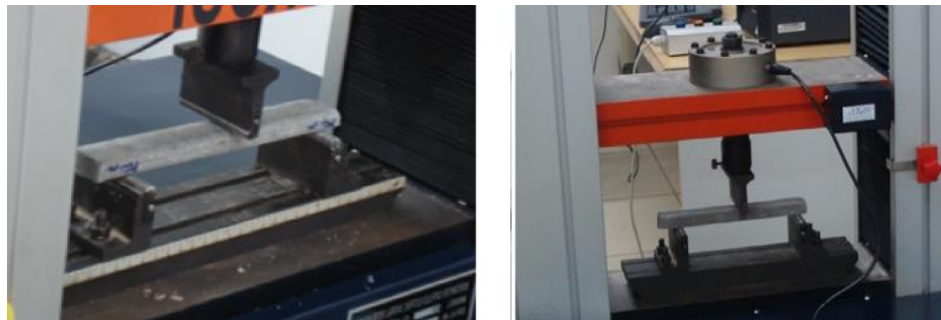
Figura 8 Testes mecânicos executados em uma máquina de testes universal da marca Arotec e equipada com célula de carga de 20 KN
