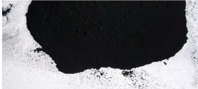
Figura 4- Cinzas provenientes da queima de borracha de pneu automobilísticos fora de uso
