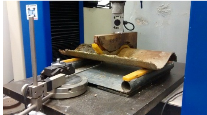
Figura 6 Ensaio mecânico das telhas onduladas
