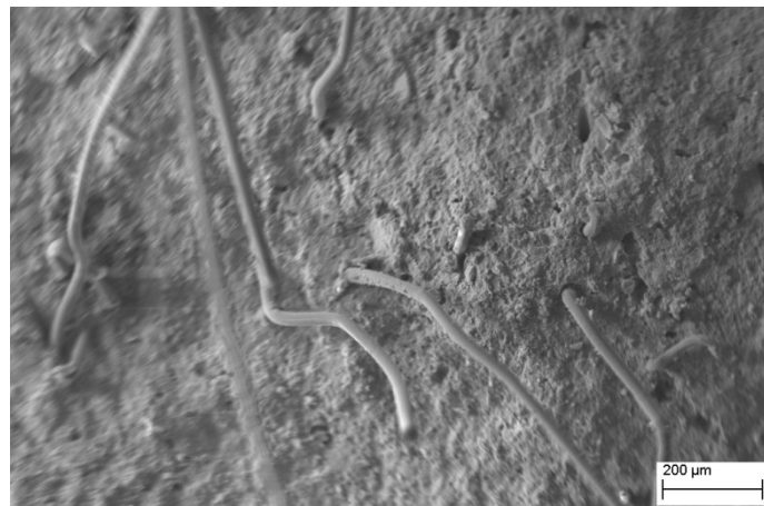
Figura 23 Microscopia eletrônica de varredura (MEV) da superfície de ruptura de uma telha reforçada com 3% Cel + 0,5% PP não carbonatada
