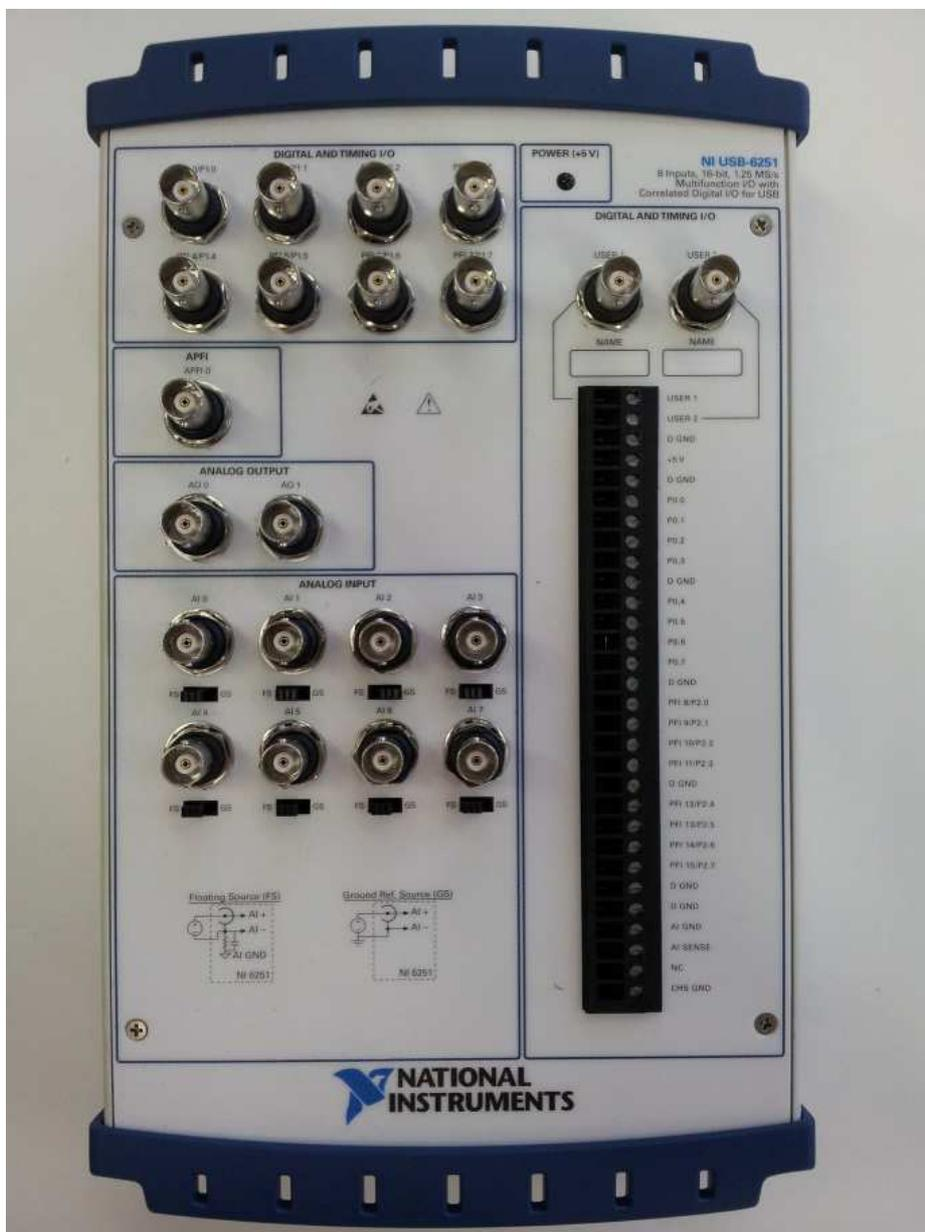
Figura 1 Placa de aquisição *NI USB-6251* fabricado por: National Instruments
