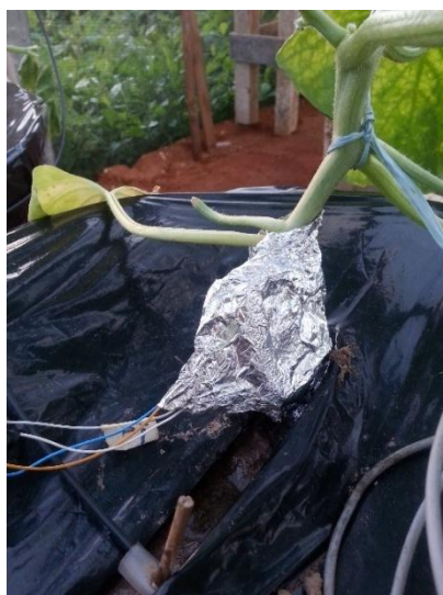
Figura 6 Isolamento térmico do caule com papel alumínio
