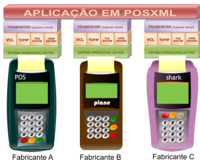
Figura 4.6: Portabilidade de uma aplicação em POSXML para vários terminais
