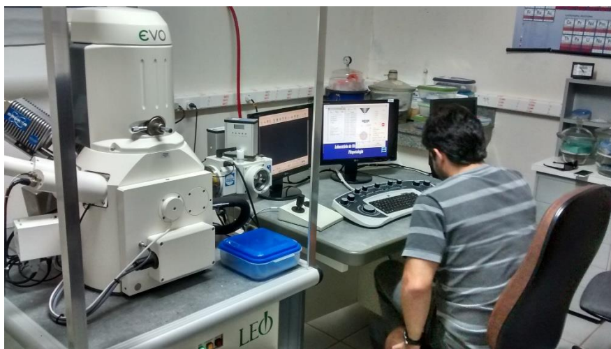
Figura 6 Conjunto para observação do diâmetro dos lumes, largura e espessura das fibras no microscópio eletrônico de varredura
