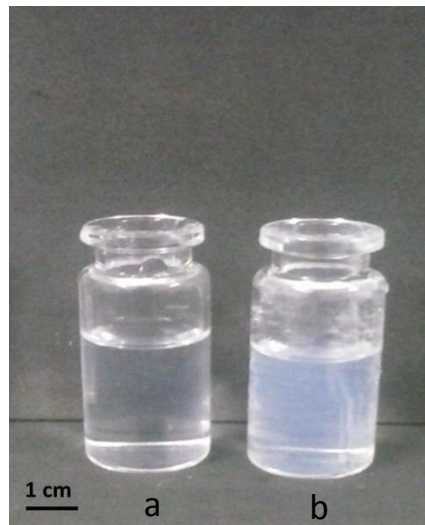
Figura 5 Nanopartículas de sílica em solução coloidal. a) S1 (3 nm); b) S3 (11 nm)
