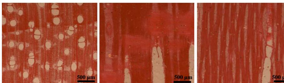
Figura 4 Planos de corte da madeira de Caucho a) Transversal (500  $\mu\text{m}$ ); b) Tangencial (500  $\mu\text{m}$ ); c) Radial (500  $\mu\text{m}$ )
