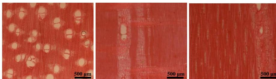
Figura 6 Planos de corte da madeira de Cedro Indiano. a) Transversal (500  $\mu\text{m}$ ); b) Tangencial (500  $\mu\text{m}$ ); c) Radial (500  $\mu\text{m}$ )
