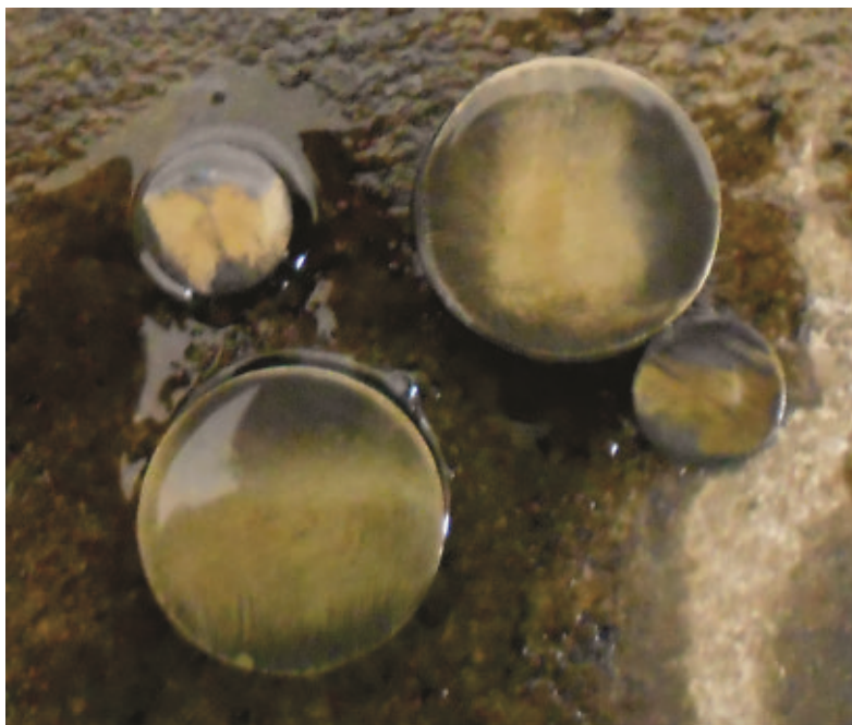
Figura 20 Detalhe da cor do revenimento "palha escuro" (aproximadamente 300 °C)
