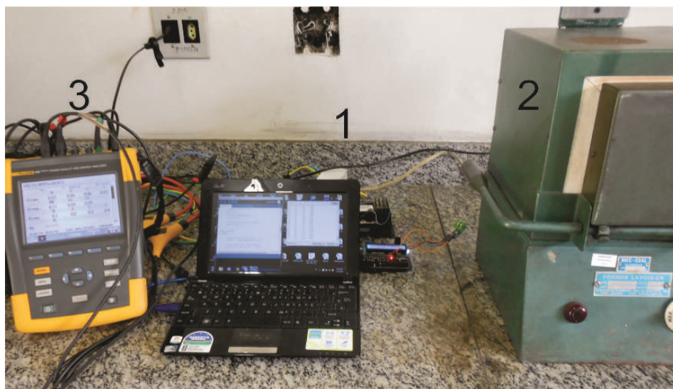
Figura 21 Registros dos dados de tratamento térmico: (1) registrador de temperatura; (2) forno com termopar; (3) analisador de qualidade de energia e potência
