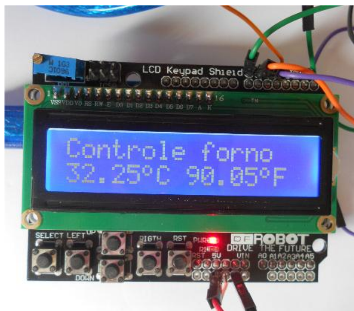
Figura 16 Detalhe do display LCD com o controle de temperatura
