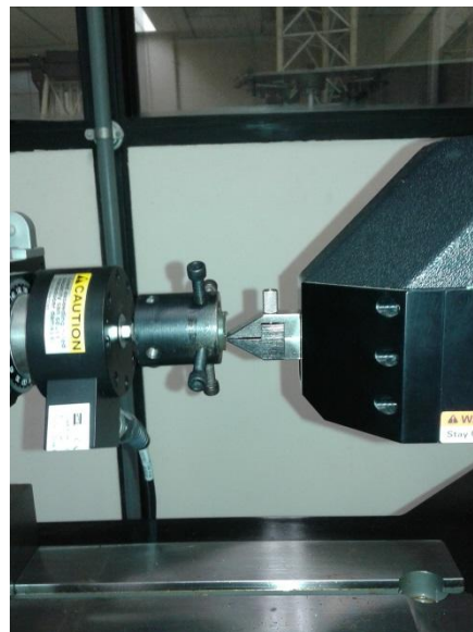
Figura 2 - Teste de pullout para fibra de juta sem tratamento.
