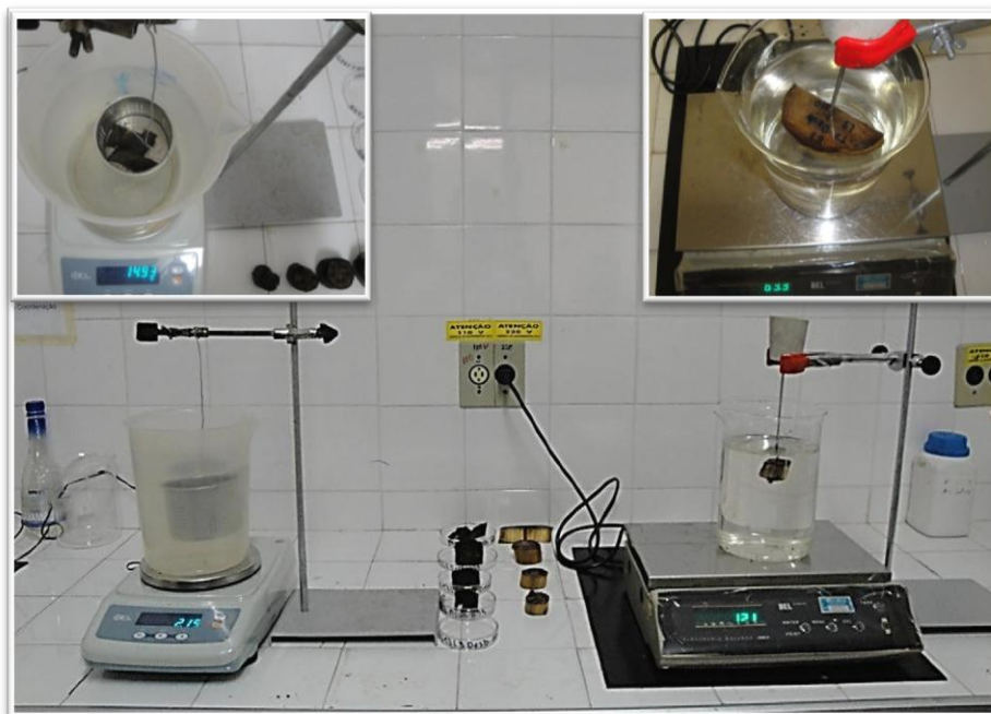
Figura 11 Medição do volume saturado por meio do princípio de Arquimedes, a esquerda para a casca e a direita para o lenho
