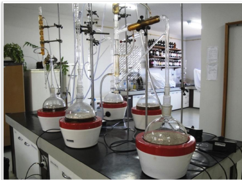
Figura 13 Hidrodestilação para a extração do óleo essencial de candeia, em aparelhos de Clevenger modificado
