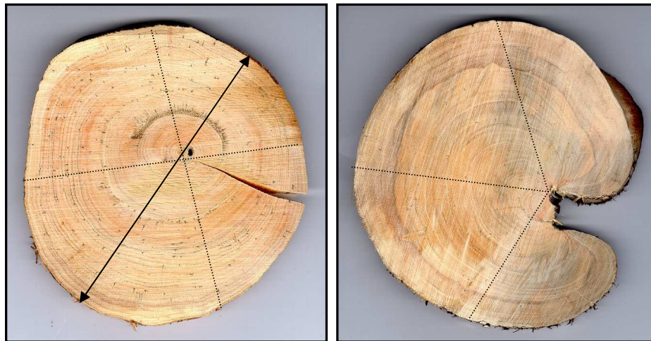
FIGURA 3.3 Posições de medição dos anéis de crescimento.
