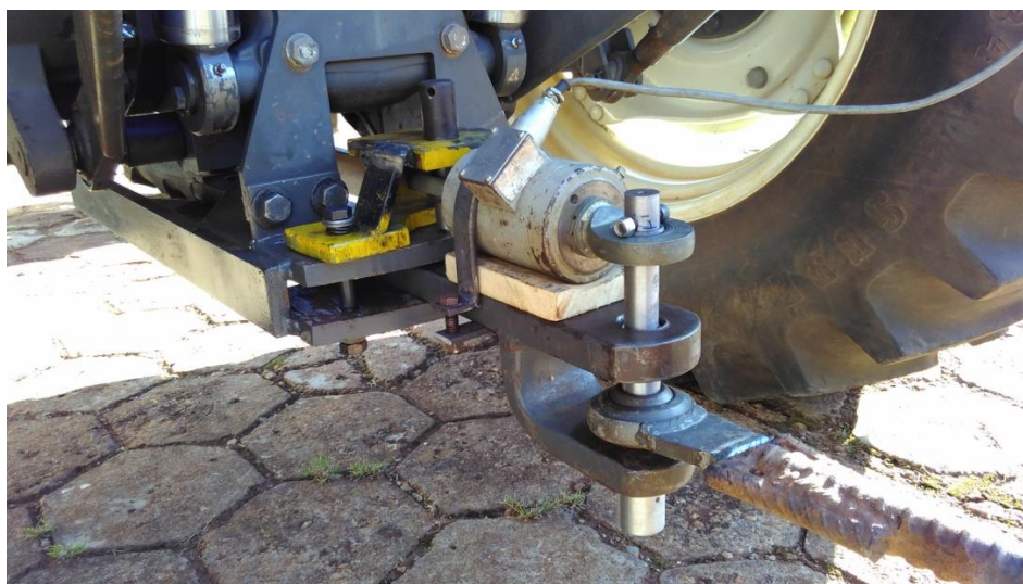
Figura 3 - Célula de carga conectada ao trator.
