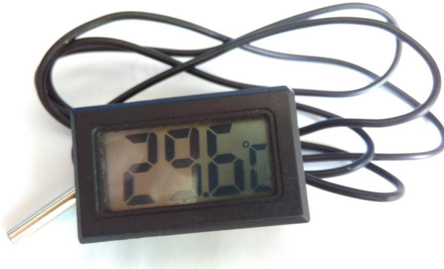
Figura 11 - Termômetro digital para a coleta da temperatura do diesel.
