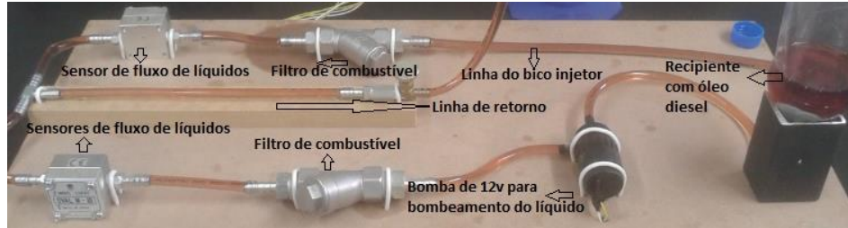
Figura 10 - Bancada de testes para calibração do fluxômetro.
