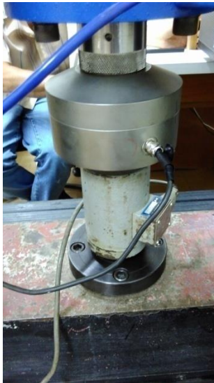
Figura 9 - Acoplamento da célula de carga à máquina de ensaio universal.
