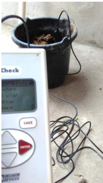
Figura 13 - Coleta do valor da capacidade de campo em balde perfurado.
