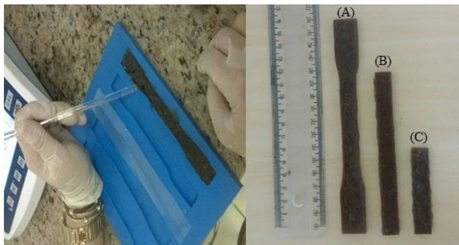
Figura 11 - Confeção dos compósitos. (A) compósito desmoldado de tração (B) compósito desmoldado de flexão e (C) compósito desmoldado de impacto.
