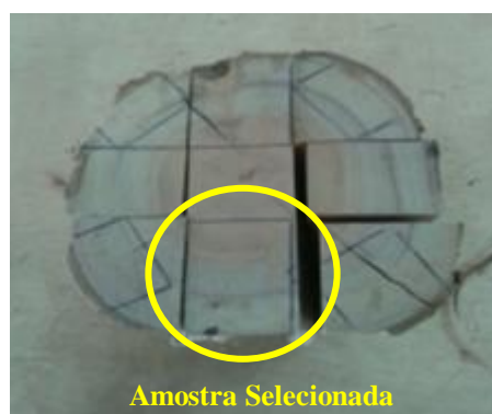
Figura 3 – Esquema de obtenção para corpo de prova para análise no NIR
