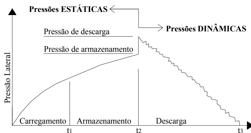
Figura 10 Pressões nas paredes do silo para um ciclo de operação de carga, armazenamento e descarga.
