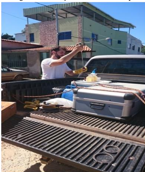
Figura 3 - Fixação do OD em campo.
