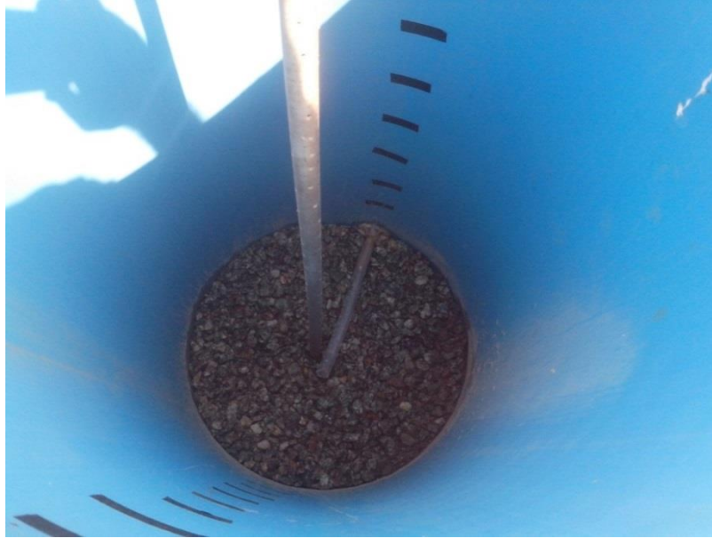
Figura 4 - Camada de drenagem do percolado e o dreno de gases.
