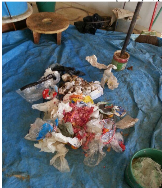
Figura 8 - Resíduos sólidos misturados na devida proporção, por camada.
