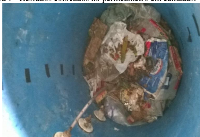
Figura 9 - Resíduos colocados no permeâmetro em camadas.
