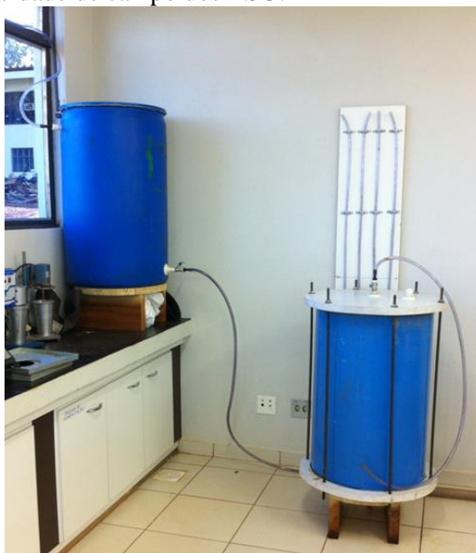
Figura 7 - Conjunto permeâmetro, reservatório e painel piezométrico utilizado para determinação da condutividade hidráulica em meio saturado e capacidade de campo dos RSU.
