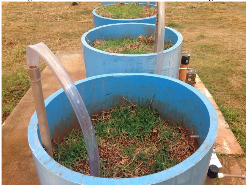
Figura 6 - Lisímetros finalizados com a cobertura vegetal.
