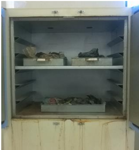
Figura 10 - Resíduos sendo secados na estufa a 60 °C.
