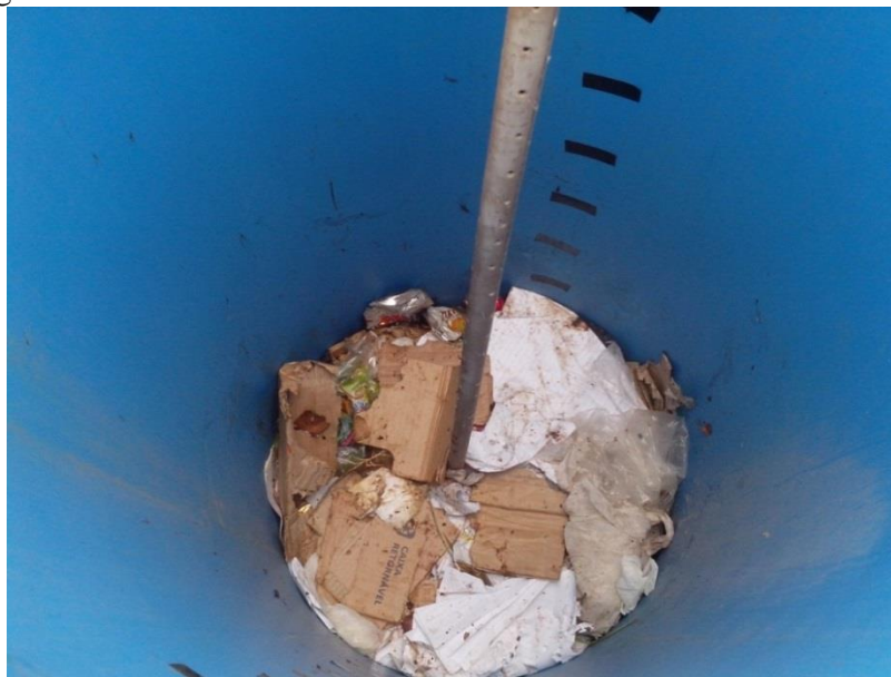
Figura 5 - Enchimento dos lisímetros com resíduos sólidos urbanos.
