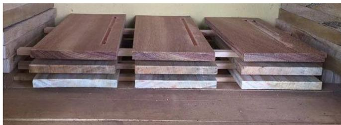
Após estabilização em cada estágio de umidade, os corpos de prova foram novamente pesados, processados de forma idêntica ao estágio inicial da madeira úmida, isto é, com as mesmas velocidades de corte e de avanço e demais controles do CNC e pesados novamente.
