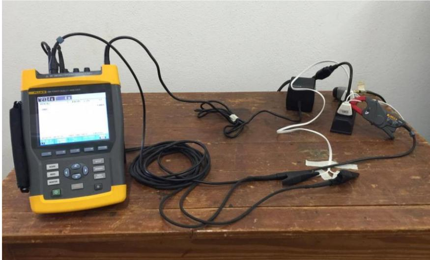
O equipamento utilizado faz a leitura de pontos de forma ininterrupta, gerando valores de potência média para o período de aquisição programado. A taxa de aquisição de dados que o FLUKE possui é de 0,0083 s, ou seja, permite a coleta de 120 dados por segundo. O modo de medição que representa o valor mínimo permitido pelo analisador ou o período em que é registrada a média dos dados coletados e gerados, foi definido em 0,5 segundos (FIGURA 8).
