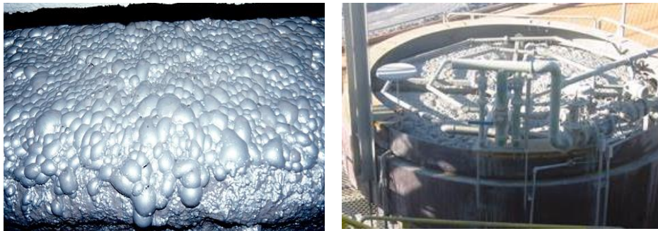
Figura 1 - Representação do processo de flotação reversa de minério de ferro
